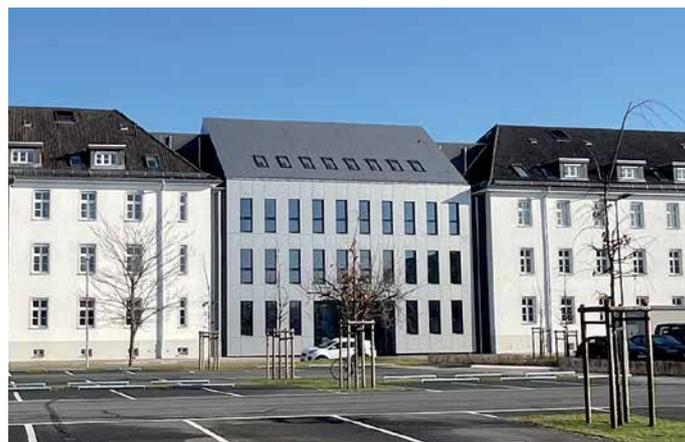
Materialien ein modernes Erscheinungsbild. Im Übergangsbereich ist eine Fuge eingearbeitet, um die Eigenständigkeit der einzelnen Baukörper zu betonen.
